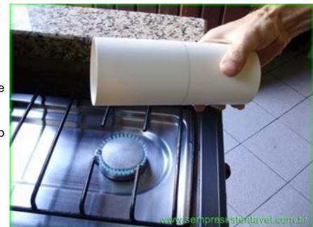
Assim que perceber que o tubo está ficando mole (para saber, aperte rapidamente com um dedo a ponta do tubo), tente encaixar por cima do tubo coberto com plástico para moldar uma bolsa na ponta desse tubo.
