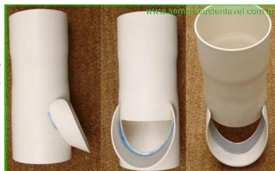
O próximo passo é fazer a Lombada Interna, que vai servir para empurrar a água de chuva forte para o centro da tela que cobre o tubo inferior, proporcionando melhor aproveitamento dessa chuva.
