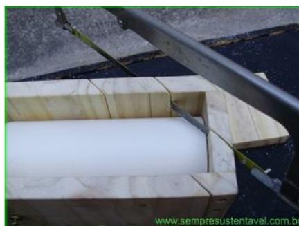
Depois faça o segundo corte nesse pedaço de tubo. Para isso, tire o parafuso, afaste um pouco o tubo até encaixar o pedaço de madeira solto do gabarito, fazendo com que o furo do tubo coincida com o segundo furo do gabarito, aquele indicado pela seta azul na primeira foto (buraco da esquerda).
