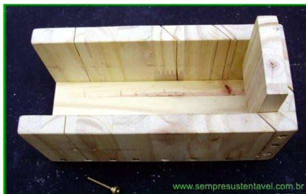
As medidas internas são: 23cm de comprimento, 7,5cm de largura e 8,5cm de altura. Além dessa "caixa", será necessário ter mais um pedaço de madeira de 7,5cm de largura por 8,5cm de comprimento. Essa peça será para fazer o terceiro corte (linha azul).
