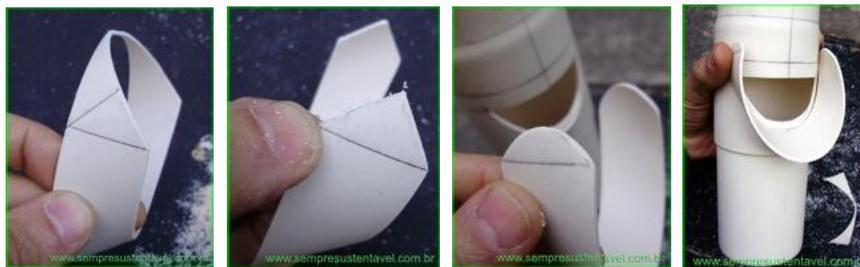
Depois cole esse bico com cola de PVC conforme está sendo mostrado na foto ao lado. Não precisa fazer uma colagem muito perfeita e nem muito reforçada. Isso porque o reforço e o acabamento você vai fazer com Durepox.
