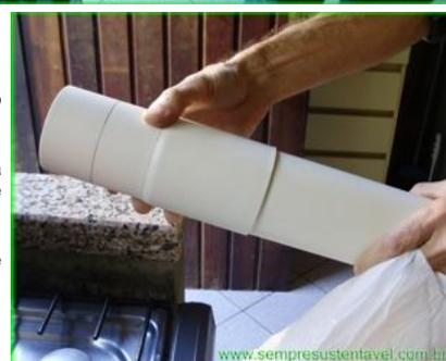
Agora vamos preparar a peça de baixo desse filtro. Para isso, comece cortando um pedaço de tubo de 75mm com 19cm de comprimento usando o gabarito, assim como fez com o primeiro pedaço.
