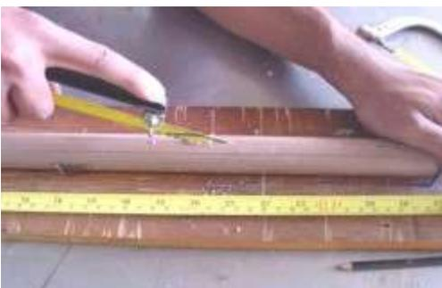
4. Uma vez realizados os dois cortes e retirada a tira, dar acabamento com a lixa nas superfícies cortadas e arredondar, com lima redonda, as extremidades do rasgo, levando para a largura original da placa alveolar, de 62 cm. Em seguida lixar e limpar com álcool.
