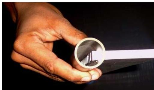
7. Utilizando a espátula, passar adesivo nas duas linhas ao longo dos 2 contatos tubos/placa do lado superior do coletor. Após 2 horas vire o conjunto tubos/placa e repita a operação de colagem no outro lado. Se estiver usando adesivo araldite ou resina isofitálica repita a operação somente no dia seguinte. No caso do adesivo Plexus pode-se virar a placa praticamente na mesma hora.
