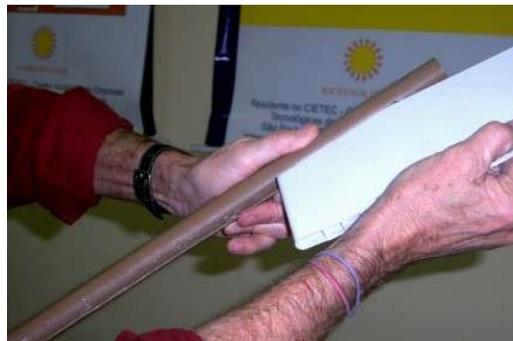
**Observação:** No caso de montar dois ou mais coletores fazer 2 gabaritos (ripas de madeira ou tubos de PVC), idênticos, de 123 cm cada e utilizá-los como régua-guia nas laterais de todos os coletores na hora da colagem para garantir a mesma distância entre os tubos de entrada e saída de água, o que permitirá fácil encaixe com luvas de coletor a coletor.
