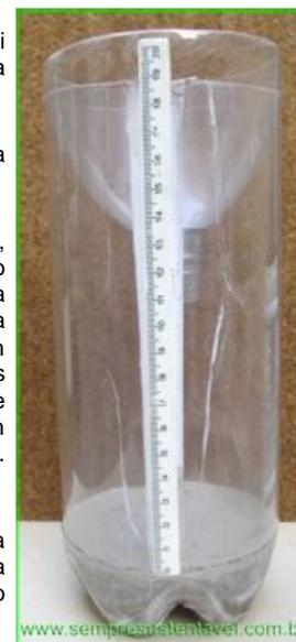
A condição ideal para instalar um pluviômetro é em campo aberto e pelo menos a 1,5m de altura.
